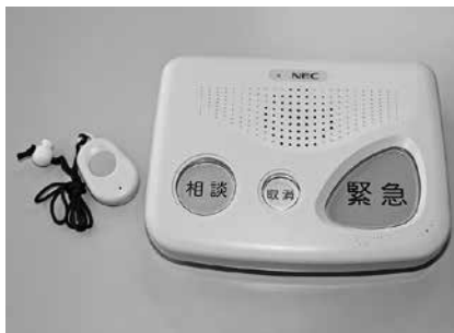
▲緊急通報システム
