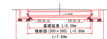
平和台7号通り横断管渠工 1:100
