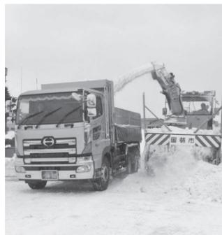
▲路面の除排雪を行う除雪車
