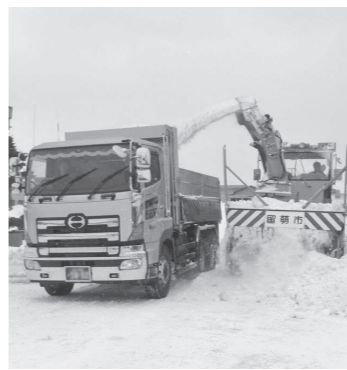
▲路面の除排雪を行う除雪車
