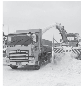
▲路面の除排雪を行う除雪車
