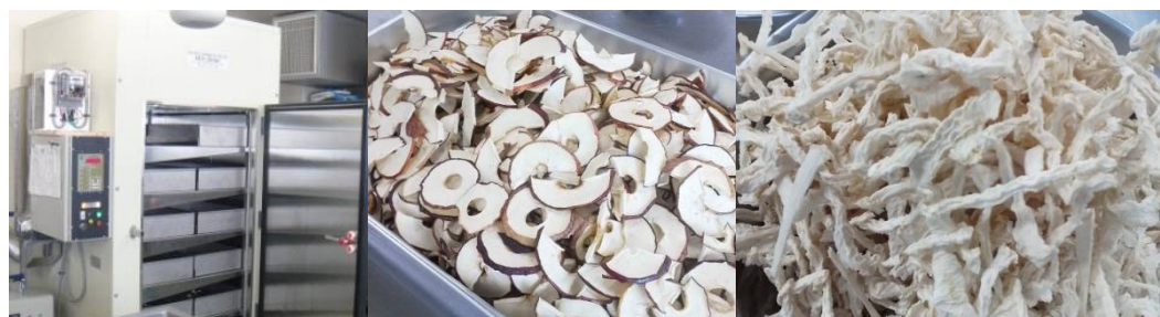
こさえーるに設置した減圧平衡発熱乾燥機と乾燥果実(りんご、大根)
