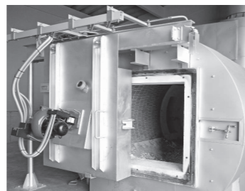
▲小平町に設置されている有害鳥獣焼却炉
