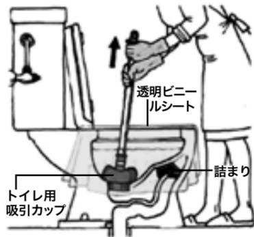
排水口にトイレ用吸引カップをあて、上下させるように吸い出します。
