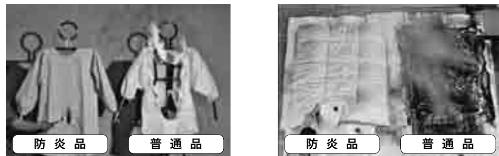
2枚の写真は防炎品と普通品へ同時に着火し、延焼を比較したものです。
