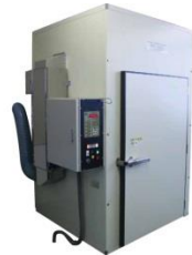
低温乾燥で栄養価を失わない減圧平衡発熱乾燥機。
